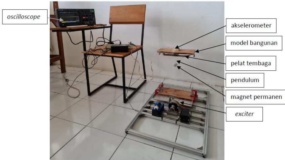
Gambar 1. Setup pengujian model bangunan dengan ECPPTMD.
