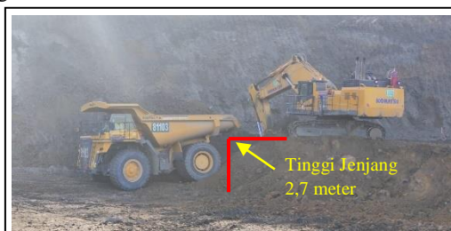
Gambar 4. Tinggi jenjang excavator loading material blasting
