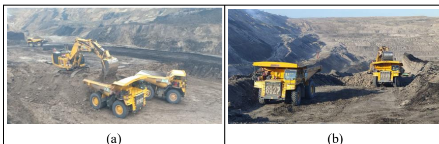
Gambar 5. a) Pola double side loading , b) Dumpruck siap mundur
