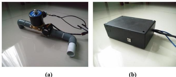
Gambar 5. Penampakan bagian instalasi pipa dan kontrollor
