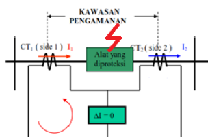
Gambar 2. Kondisi Gangguan Dalam Differential Relay [1]
