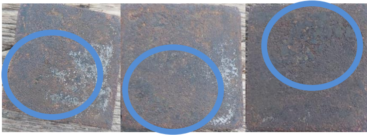
Gambar 4.2 Korosi yang terjadi pada sampel
