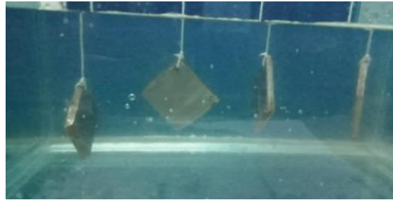
Gambar. 2 Proses Perendaman Spesimen Stainless Steel
