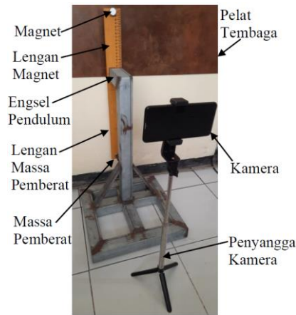
Gambar 2. Alat pengujian respons getaran pendulum.
