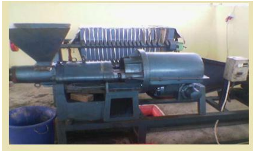
Gambar 5. Mesin Pres Untuk Melumatkan Biji-Bijian Agar Keluar Minyak
