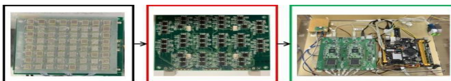
Gambar.1 Sistem detektor sintilator plastik dari kiri; Scintillator plastik ditambah dengan papan SiPM multichannel, papan dTOT, sistem DAQ.
