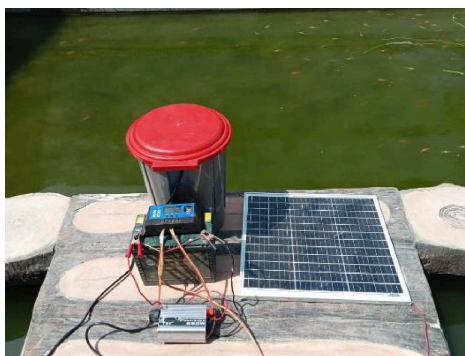
Gambar 8. Rangkaian Panel Surya sebagai catu daya alat pemberi pakan
