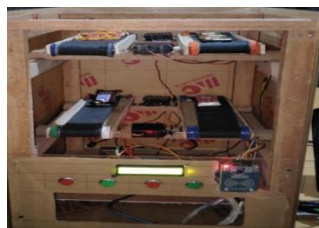
Gambar 4. Bentuk konveyor pada vending machine.
