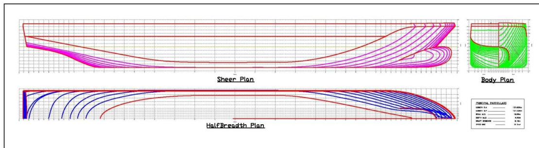
Gambar 5. Lines Plan Dengan Bulbousbow
