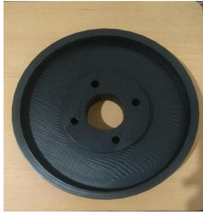
Gambar 12. Prototipe pulley motor induksi diameter 23 cm
