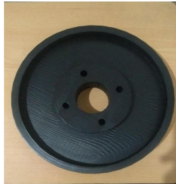
Gambar 5. Prototipe pulley motor induksi diameter 23 cm
