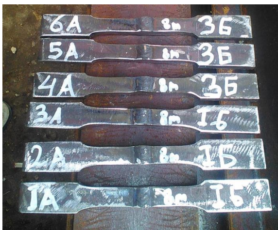
Gambar 3: Pelat SA36 tebal 8mm
