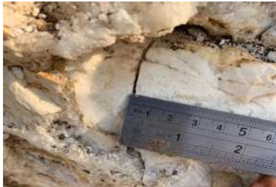
Gambar 6 : Kondisi Pelapukan Kekar Pada Lereng Penelitian (a) Agak Lapuk, (b) Pelapukan Sedang dan (c) Tidak Lapuk
