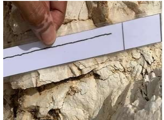
Gambar 4 : Kondisi Kekasaran Diskontinu Pada Lereng Penelitian, (a) Rough dan (b) smooth
