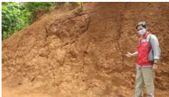
Gambar 7: Soil yang tebal dan retakan-retakan padanya kemungkinan merupakan kekar akibat struktur geologi tertentu
