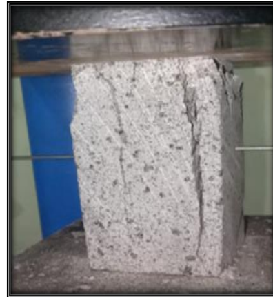
Gambar 3: Keadaan sampel batuan 1 setelah diuji.
