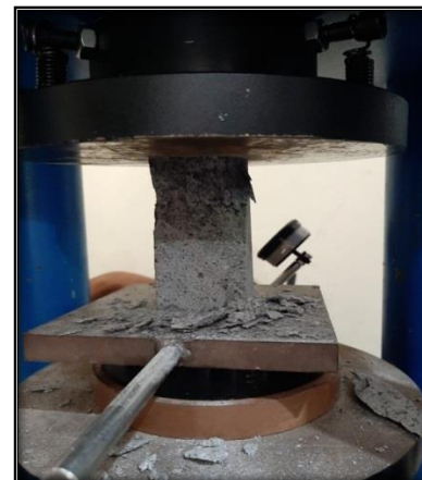
Gambar 4. Keadaan sampel batuan 2 setelah di uji.
