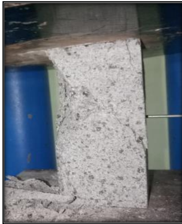
Gambar 5: Keadaan sampel batuan 3 setelah di uji.
