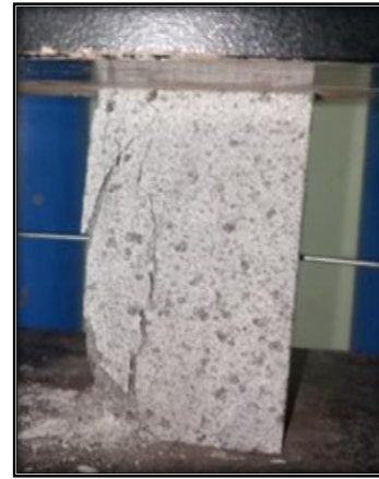
Gambar 7: Keadaan sampel batuan 5 setelah di uji.
