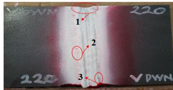
Gambar 21: Cacat Las Incomplete Fusion (1), Over Spatter (2), Undercut (3) pada Sampel 2 B
