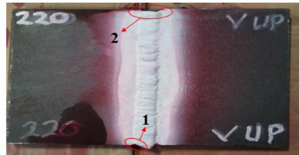
Gambar 17: Cacat Las Undercut (1), Incomplete Fusion (2), pada Sampel 1 B
