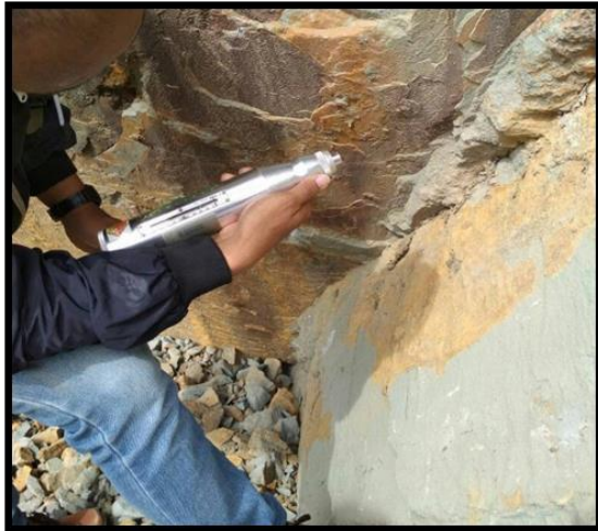
Gambar 3: Pengujian kuat tekan batuan dengan schmidt hammer.
