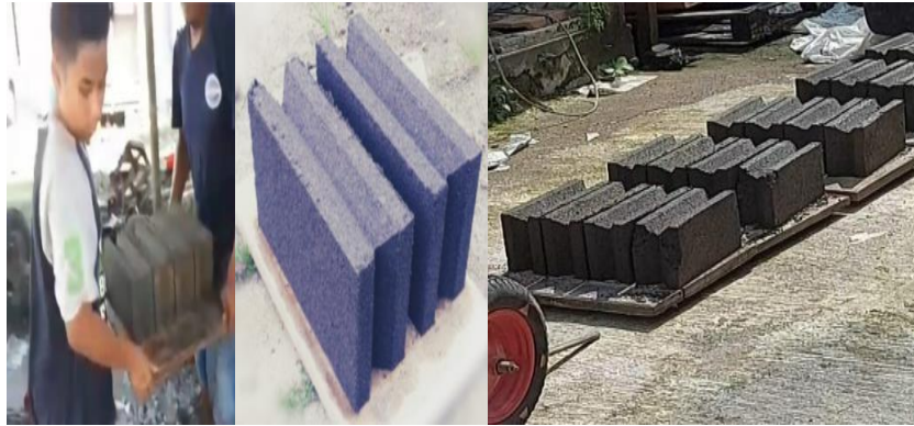
Gambar 5. Proses pengeringan batako secara manual
