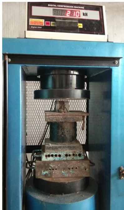
Gambar 9. Kenampakan Uji Kuat Tekan pada sampel Batu Andesit
