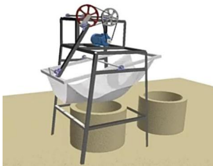
Gambar 2. Penerapan TTG Mesin Penyaring (Pemisah) Sari Kedelai dengan Ampas
