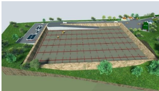
Gambar 9. Desain Pipa Pengumpul Lindi dan Penangkap Gas TPA Juata Kerikil
